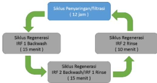
Gambar 13. Diagram siklus dan waktu operasi unit IRF.
